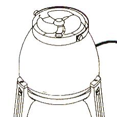
Conectar directamente el aparato a la red para una evaluación del funcionamiento. Escuchar el sonido del motor. El funcionamiento debe ser suave y silencioso. El eje del motor debe estar centrado y vertical. Make any necessary adjustments. After evaluation, connect HR-50 to desired control device as you see options.
